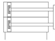
Zyl., doppelwirkend, ausgef., Magnetkolben
