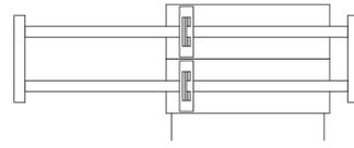
Zyl., doppelw., durchg. Kolbenst., Magnetkolben, ausgef.
