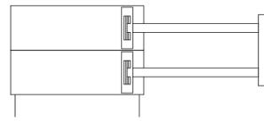
Zyl., doppelwirkend, durchg. Kolbenst., Magnetkolben
