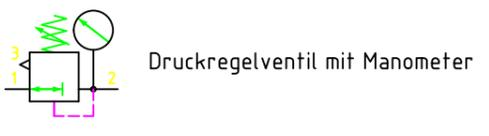
Druckregelventil mit Manometer
