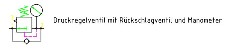
Druckregelventil mit Rückschlagventil und Manometer
